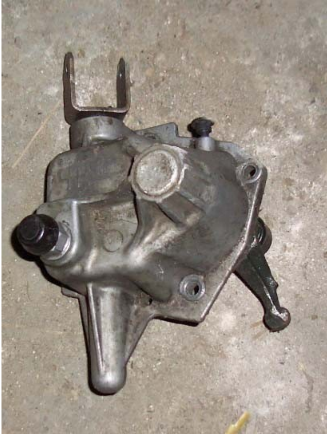
So sieht der Schaltautomat aus, wenn man von oben aufs Getriebe schaut.
